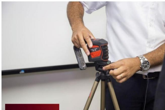
Nível laser pode ser utilizado associado a um tripé comum
